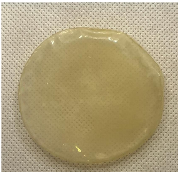
شکل ۲. فیلم کامپوزیت مبتنی بر کیتوزان حاوی اسانس گیاه خانواده نعنائیان
