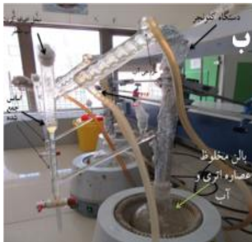
شکل ۱: الف) دستگاه سوکسله: جهت استخراج عصاره های مختلف گیاهی. ب) دستگاه کلونجر: جهت استخراج اسانس با استفاده از بخار
